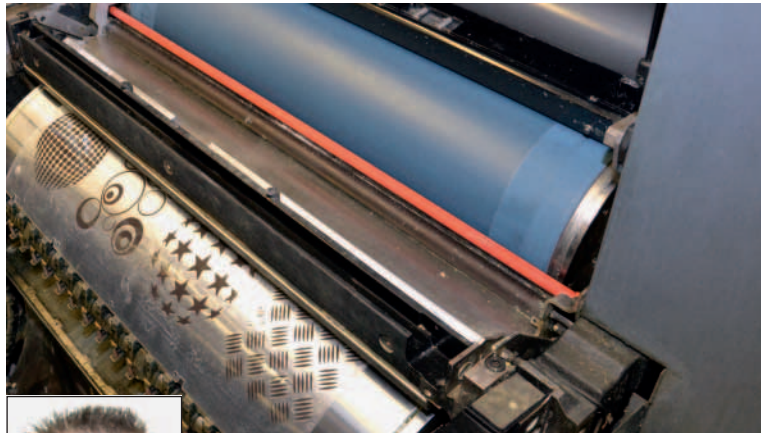
Blick in ein Lackwerk einer Bogenoffset-Druckmaschine bei Bruns Druckwelt. Deutlich zu sehen ist die partiell magnetisierte Folie auf dem Gegendruckzylinder.
